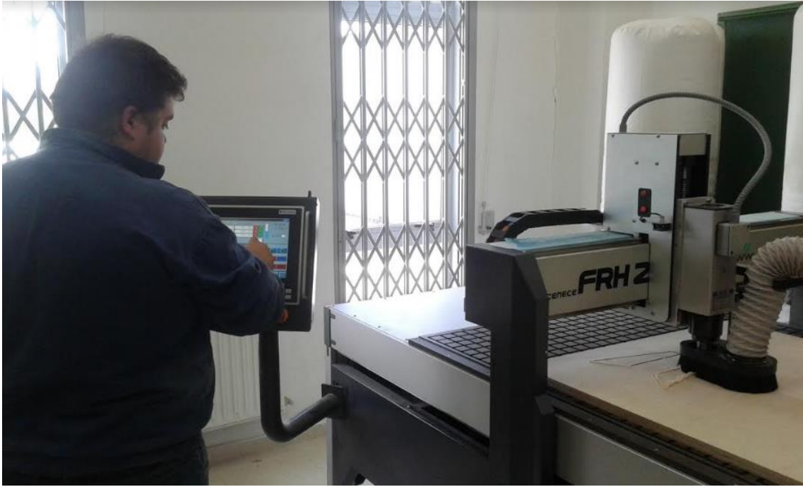
Traslado dos datos do mecanizado á máquina de control numérico CNC
